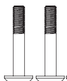
INVÄNDIG SEKKANTIG SKRUV (M8x50x20) 4ST
