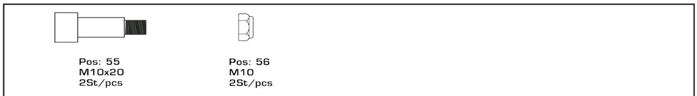
Verbinden Sie beide Pedalarms (5, 6) mit den beweglichen Armen (8, 9) mit einer Innensechskantschraube (55) und einer selbstsichernden Mutter (56).
